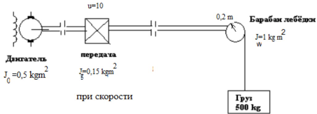
Рис. 1. Структурная схема приводного механизма
