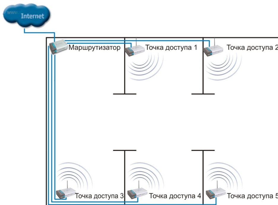
Рис. 1.59 Объединение точек доступа через проводную инфраструктуру
