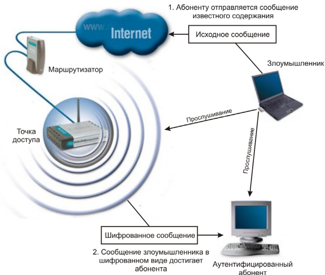
Рис. 2.14 Повторное использование вектора инициализации
