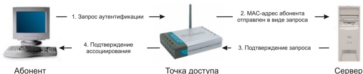
Рис. 2.21 Аутентификация с помощью внешнего сервера
