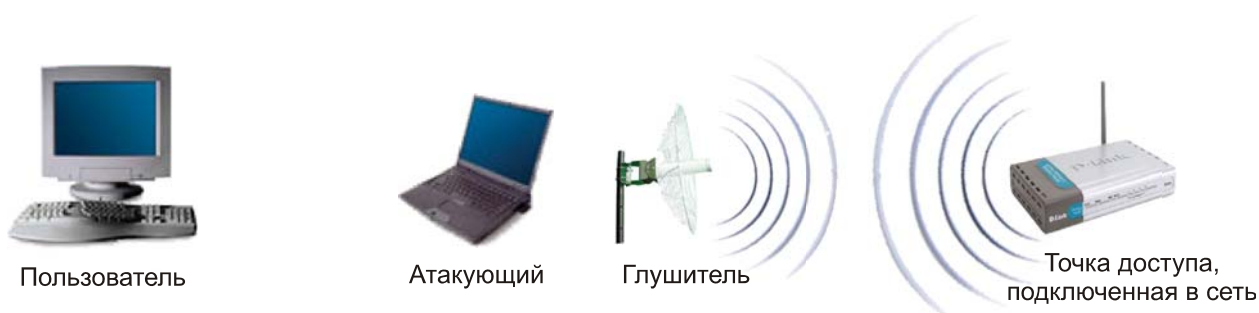
Рис. 2.4 Атака глушения базовой станции для перехвата соединения
