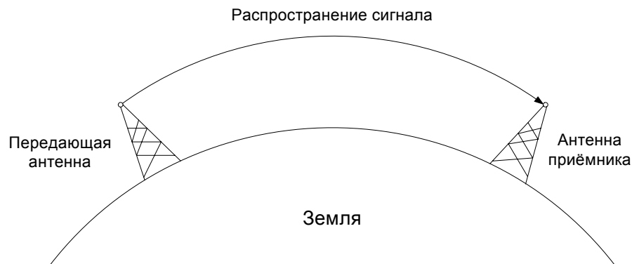
Рис. 3.3 Распространение околосемных волн (частота до 2 МГц)
